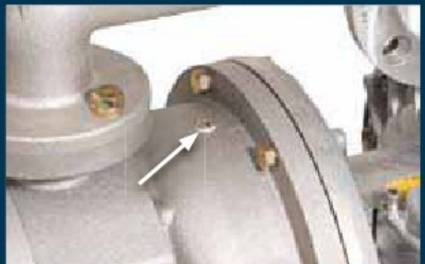
Výpustné otvory zmiernujú vyparovanie paliva a pomáhajú s plnením čerpadla vodou
