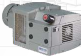
Sucho bežné lamelové vývevy Busch®, Rietschle®, Becker®, Thomas®, prietok do 570 m 3 /hod., tlak do 100 mbar(abs.)
