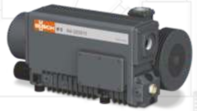
Olejové lamelové vývevy Busch®, Rietschle®, Becker®, Pfeiffer®, Leybold®, prietok do 1800 m 3 /hod., tlak do 0,5 mbar(abs.)
