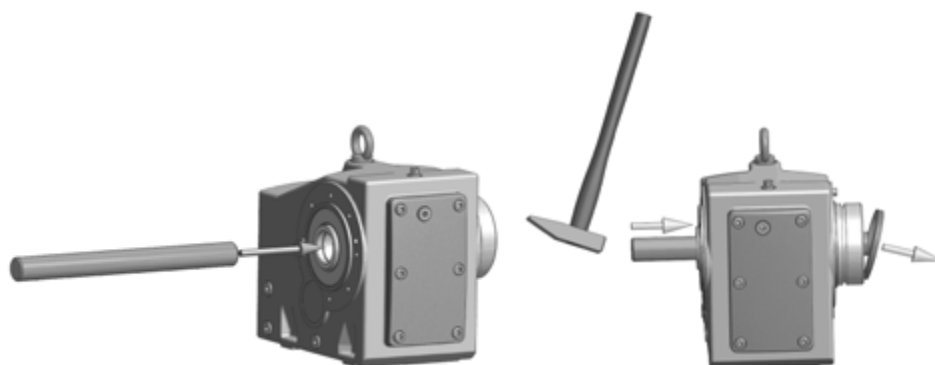
Obrázok 7: Demontáž uzatváracieho krytu namontovaného od výroby
