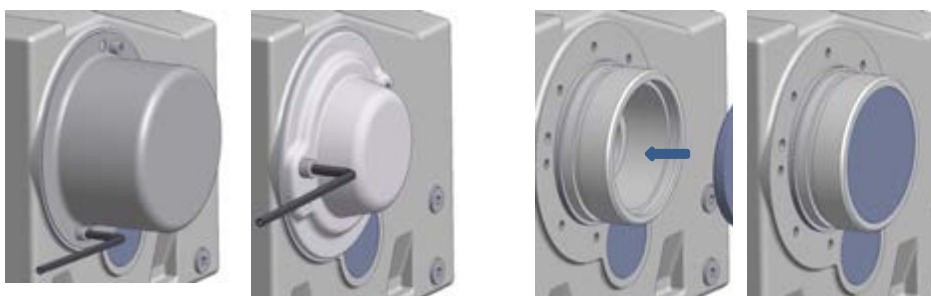
Obrázok 14: Montáž krytu voľba SH, voľba H a voľba H66
