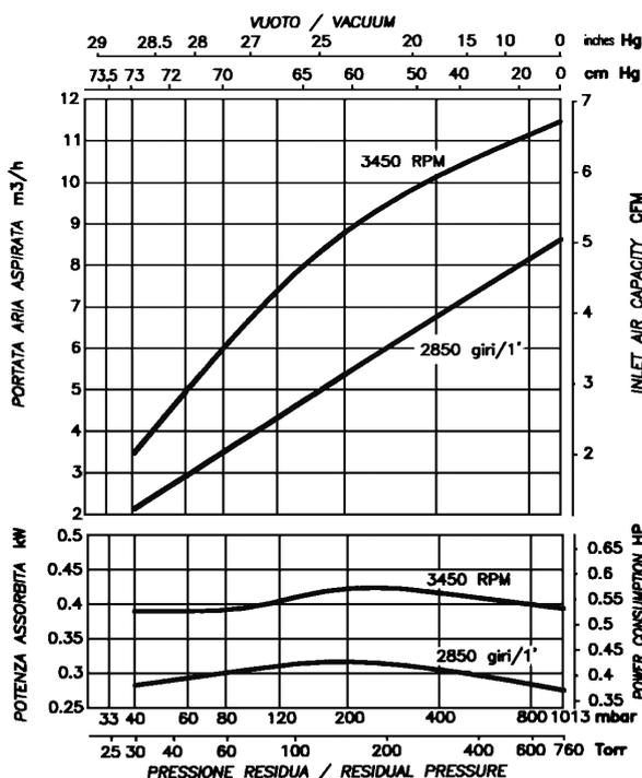
I valori di portata sono riferiti ad aria secca, alla temperatura di 20°C, alla pressione atmosferica di mandata (1013 mbar), e all'impiego di acqua alla temperatura di 15°C. Tolleranza di prestazione ± 10%. Nell'esecuzione in inox la portata diminuisce del 10%. I dati sopraindicati possono essere variati senza preavviso.
