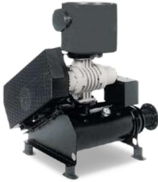
Das berührungslos arbeitende 2-flügelige (R-WPB 25) bzw. 3-flügelige (R-WPB 120 bis 8.300) Wälzkolbengebläse ist für den Druckbetrieb bis max. 2 bar (abs.) geeignet. Die 18 Baugrößen haben einen Volumenstrom von 20 bis max. 8.000 m<sup>3</sup>/h. Geräusch- und pulsationsarm, hoher Wirkungsgrad durch optimale Gebläsedrehzahlen, stabile Ausführung, servicefreundlich.
