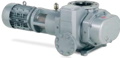
Berührungslos arbeitende Wälzkolbenpumpe mit Saugvermögen 2.293 bis 2.752 m<sup>3</sup>/h, vorzugsweise zum Abpumpen von Gasen und Dämpfen im Grob- und Feinvakuumbereich, da weitgehend unempfindlich gegen Wasserdampf und korrosive Dämpfe. Zum Erreichen des erforderlichen Vorvakuums wird eine Vorpumpe benötigt. Die Flanschmotoren entsprechen DIN EN 60034 Isolationsklasse F ausgeführt.
