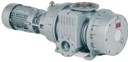
Berührungslos arbeitende Wälzkolbenpumpe mit Saugvermögen 485 bis 1.909 m<sup>3</sup>/h, vorzugsweise zum Abpumpen von Gasen und Dämpfen im Grob- und Feinvakuumbereich, da weitgehend unempfindlich gegen Wasserdampf und korrosive Dämpfe. Zum Erreichen des erforderlichen Vorvakuums wird eine Vorpumpe benötigt. Die Flanschmotoren entsprechen DIN EN 60034, sind in Schutzart IP 55 und Isolationsklasse F ausgeführt.
