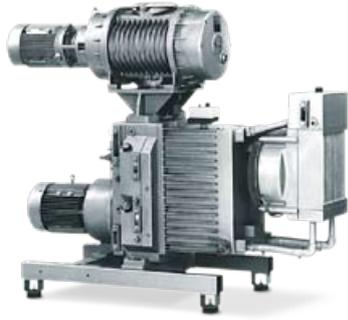
Pumpstände, bestehend aus V-VWZ und Wälzkolben-Gebläse. Verbinden die Vorteile der frischölgeschmierten Pumpen mit dem hohen Saugvermögen der Wälzkolben. Die Flanschmotoren entsprechen DIN EN 60034, sind in Schutzart IP 55 und Isolationsklasse F ausgeführt.
