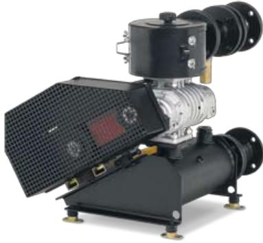
Das berührungslos arbeitende 2-flügelige (R-WVB 25) bzw. 3-flügelige (R-WVB 120 bis 8.300) Wälzkolbengebläse SHARK ist für den Vakuumbetrieb bis max. 0,5 bar (abs.) geeignet. Die 16 Baugrößen haben ein Saugvermögen von 22 bis 8.580 m³/h. Geräusch- und pulsationsarm, hoher Wirkungsgrad durch optimale Gebläse-drehzahlen, stabile Ausführung, service-freundlich.
