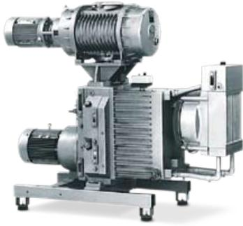
Pumpstände, bestehend aus V-VWZ und Wälzkolben-Gebläse. Verbinden die Vorteile der frischölgeschmierten Pumpen mit dem hohen Saugvermögen der Wälzkolben. Die Flanschmotoren entsprechen DIN EN 60034, sind in Schutzart IP 55 und Isolationsklasse F ausgeführt.
